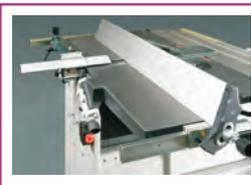
Der überdimensionierte harteloxierte Abrichtanschlag. Mittels eines Spezial-Schwenkkopfs liegt der Anschlaglineal auch beim Schwenken auf 45° noch auf dem Tisch auf. Die Endanschläge sind auf 45° und 90° einstellbar.
