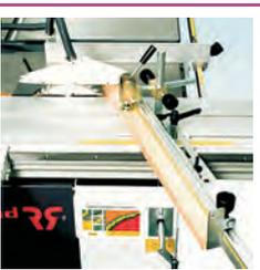
Über den, auf dem Schiebeschlitten aufgebauten, Gehrungsanschlag mit Anschlagbacken und Exzentranspanner kann jede beliebige Gehrung eingestellt werden. Da der Schwenkpunkt des Gehrungsanschlages nicht am Rahmentisch ist, steht immer die volle Auflagefläche zur Verfügung.
