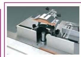
Frässpindel mit Standarddurchmesser von 30 mm (Option 50 mm) und einer Werkzeugaufnahme von 125 mm. Höhenverstellbarkeit der Frässpindel 140 mm. Eingebaute Frässpindel-Arretierung über Hebel zum bequemen Werkzeugwechsel. Der Fräsanschlag ist mit Holzdrücker für eine optimale Sicherheit ausgestattet.
