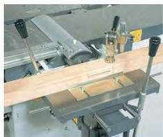
Der leichtbewegliche Bohrtisch garantiert eine bequeme Handhabung. Die Bedienhebel sind zur Bearbeitung großer Werkstücke leicht abnehmbar. Das 2-Backen-Bohrfutter hat eine Aufnahme von 0 bis 16 mm.
