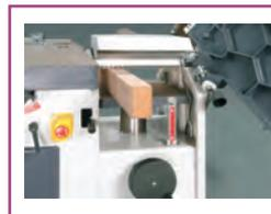
Der Durchlass beim Dickenhobel ist bis 230 mm nach Skala einstellbar. Ein Handrad garantiert ein leichtes Bedienen (eine Umdrehung ist 4 mm).
